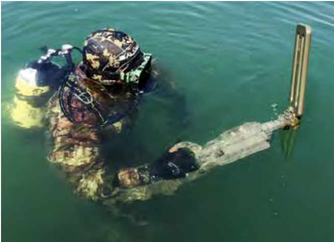
CMD/DW: Metal Detector Compatto Anfibio progettato per la rivelazione di metalli e di target a minimo contenuto metallico in acque dolci o salate fino alla profondità di 100 m.
