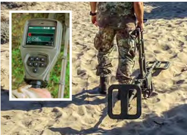
DSMD: Metal Detector digitale per l'intercettazione in profondità di ordigni inesplosi (UXO) e la Bonifica dei Poligoni, con funzionalità integrate di Controllo Qualità e Operazioni assistite.
